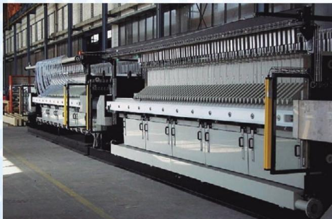
Figura 46: Planta de filtración de concentrados de cobre.
